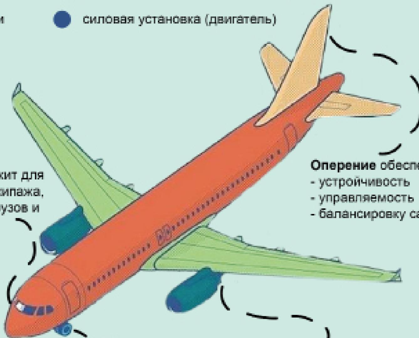
Фюзеляж служит для размещения экипажа, пассажиров, грузов и оборудования.
